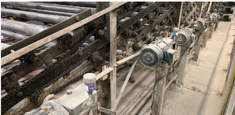
Una serie de cajas de engranajes están protegidas contra la contaminación mediante respiraderos desecantes TTI Power Breathers™. Estos evitan la entrada de partículas incluso en los entornos más adversos.
