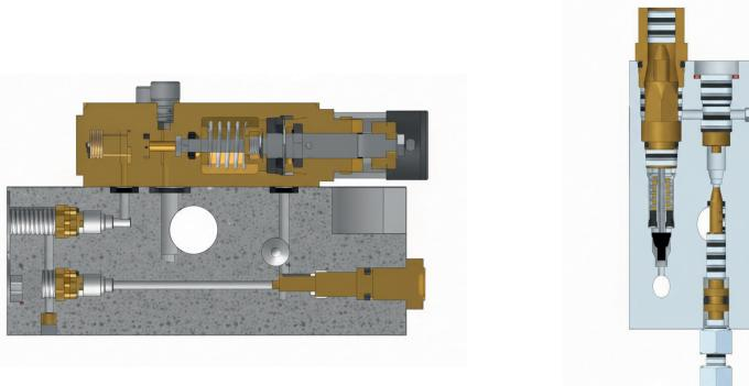
Los dosificadores volumétricos trabajan en base a los principios de funcionamiento de las instalaciones de línea simple, con la particularidad de haber añadido una entrada de aire. Dependiendo del modelo de dosificador, el caudal de aire de entrada puede ser regulable.
